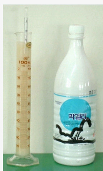
간염분 측정기와 같은 원리의 비중계가 막걸리 제조에 이용된다.
