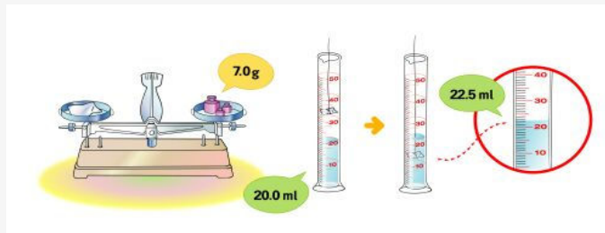
[그림 6-1.2] 알루미늄의 질량과 부피 측정
